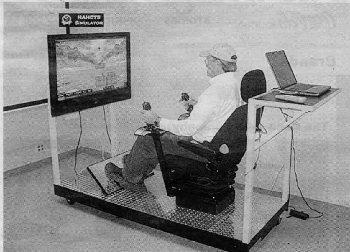
O game-based learning pode ser uma ajuda preciosa no treino do manuseamento de maquinaria. Na imagem vemos um trabalhador a receber formação no manuseamento de gruas com a ajuda de um simulador. Fonte: nahetsblog.files.wordpress.com.
