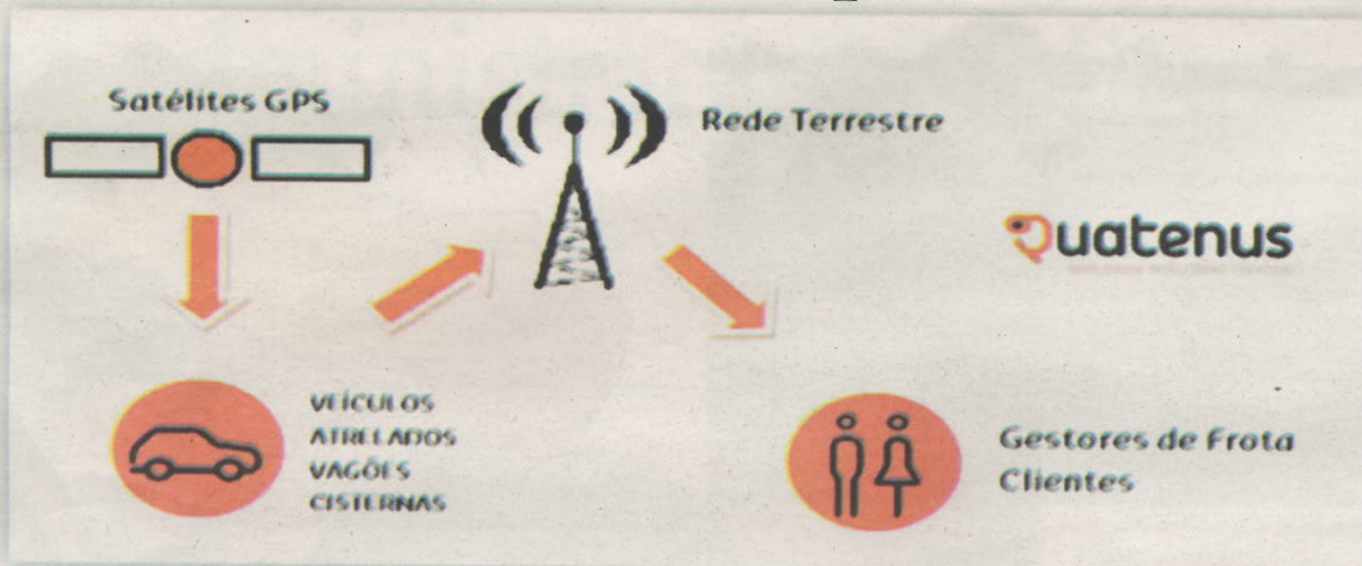
Representação esquemática simples que mostra a forma como funciona a gestão de frotas com localização por GPS.
